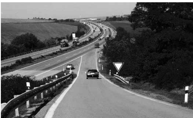
Obr. 4 Nájезд na dálnici bez připojovacího pruhu. Očekávání řidiče jsou oproti realitě naprosto rozdílné
