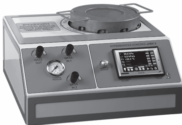
Obr. 1 Mikrohyperbarická komůrka uHBK2
