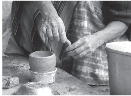
Figure 16. Rolling process, San Mateo Ixtatán, Huehuetenango, Guatemala. Photo: Julio Hernández.
